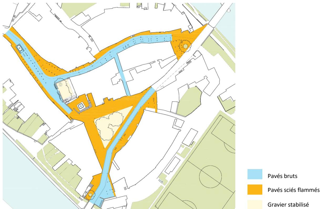
Figure 11 : Schéma des types de revêtements
