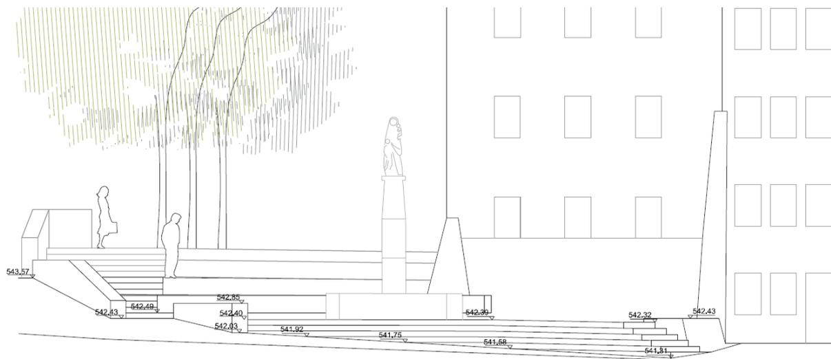
Figure 14 : Vue de la fontaine Sainte-Anne avec murets et marches en béton
